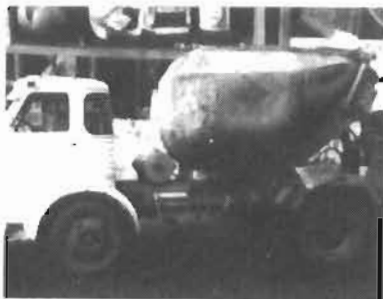
Hier : Ancienne bétonnière à cuve basculante
