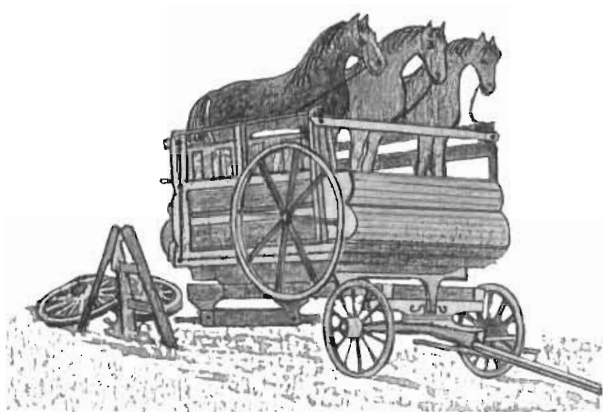
Gravure représentant la trépineuse (horse power). Machine agricole fabriquée par Matthew Moody à Terrebonne vers les années 1880
