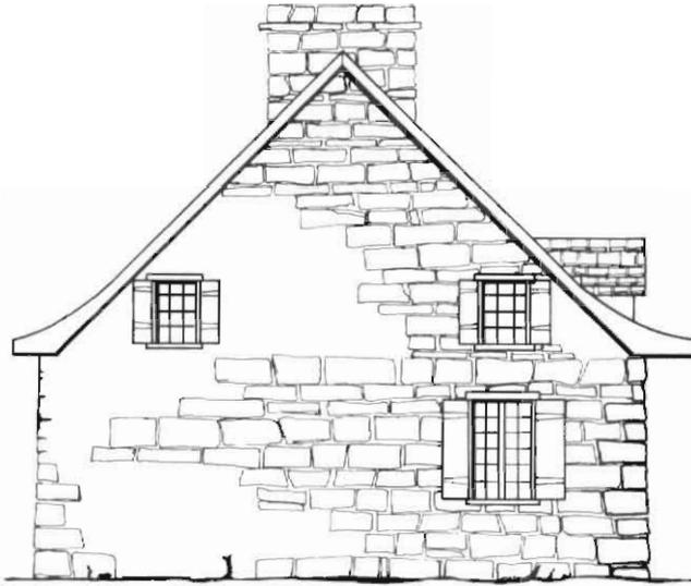
À l'origine, quatorze ouvertures percent la maçonnerie. L'équilibre de la façade s'obtient par l'emplacement harmonieux de la porte principale et des trois fenêtres. Une autre porte dans le mur pignon est facilité l'accès aux bâtiments de ferme.
