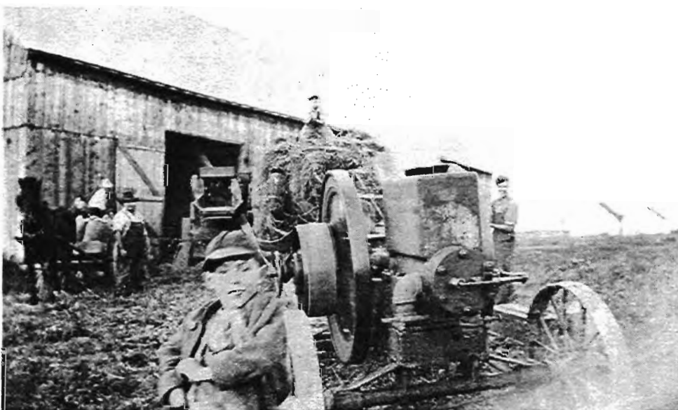
La batteuse à grain actionnée par un engin stationnaire . Les plus anciens ont connu le "haspar" (horse power), où les chevaux actionnaient la batteuse. Aujourd'hui, la moissonneuse-batteuse bat le grain sur le champ.
