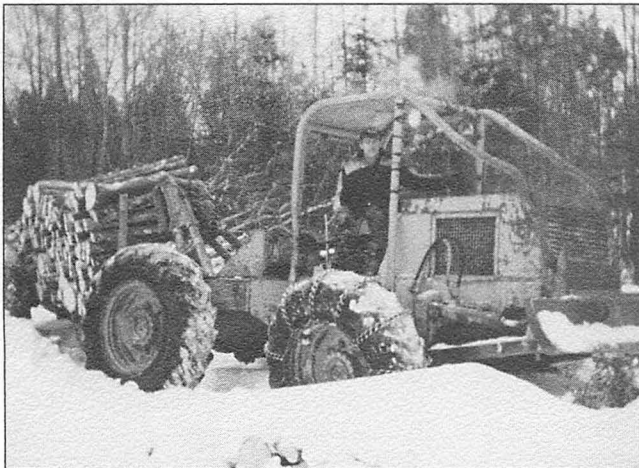
Premier équipement de Midifor inc., une débusqueuse à câble Tree Farmer C-4
