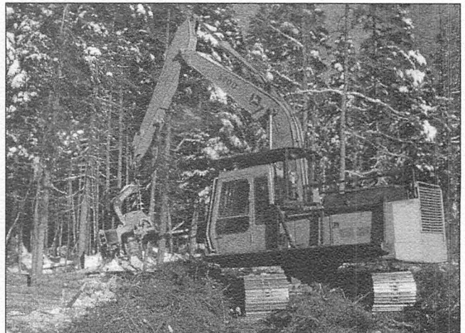
Abattage mécanisé des bois à l'aide d'une abatteuse multifonctionnelle
