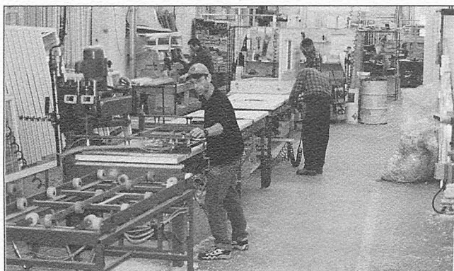
Ligne de production des portes d'acier
