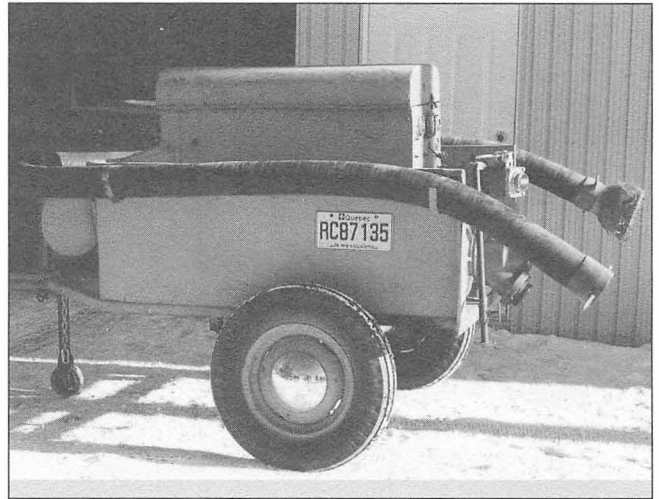
Pompe à incendie
