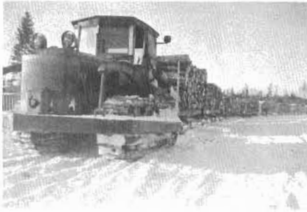
Tracteur utilisé à Baker Lake dans les années 1940 au camp de M. Adélard Gilbert. Il peut remorquer jusqu'à 25 sleighs. Chacune d'elles contient 5 à 6 cordes de bois.
