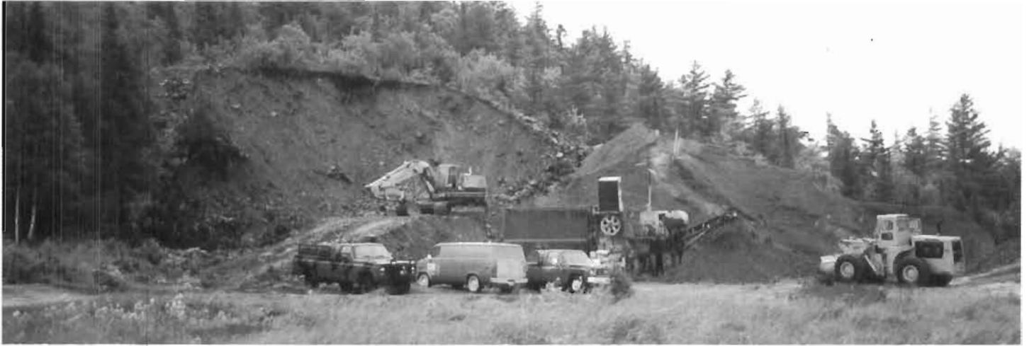
Mine Philippon (chrysotile) juillet 2001 Concassage par l'entreprise Construction Frontenac inc. Pelle mécanique de marque 235 Caterpillar Casse pierre de marque Telsmith 1969 Loader de marque Michigan 125 c 1968
