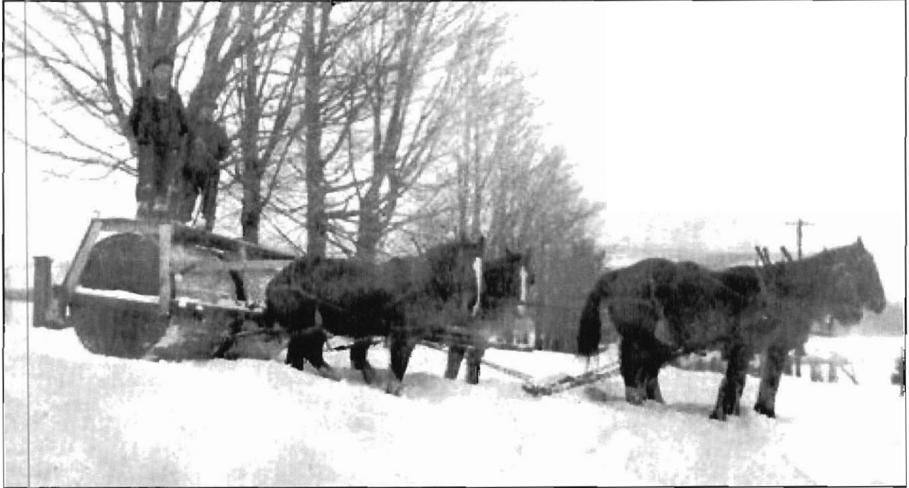
Falconer Gill et Hubert Bennett - le rouleau à neige / the snow roller
