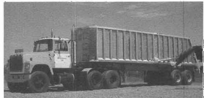
Remorque avec système de chargement hydraulique
