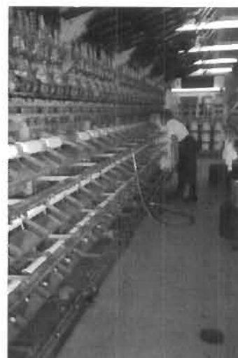
Une dame voit au bon fonctionnement d'une machine de texturation de nylon.
