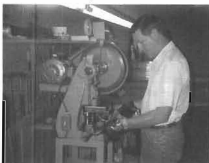
François perforant une pièce d'aluminium sur une presse
