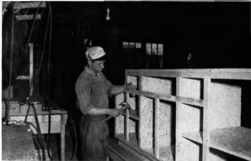
Un autre menuisier inspecte chaque armoire et y pose des clous aux endroits nécessaires afin de s'assurer d'une parfaite durée et force.
