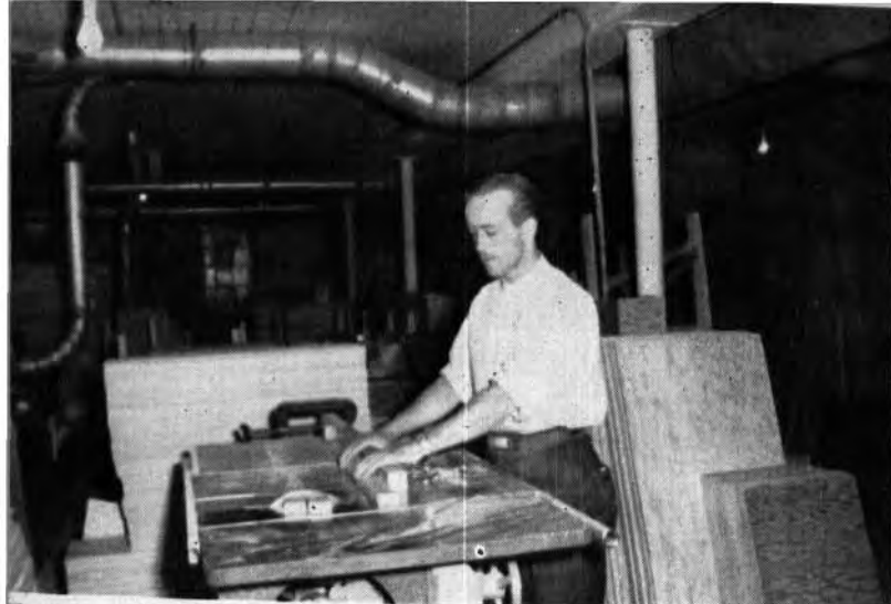
Il faut ensuite scier les panneaux de contreplaqué aux dimensions exigées.
