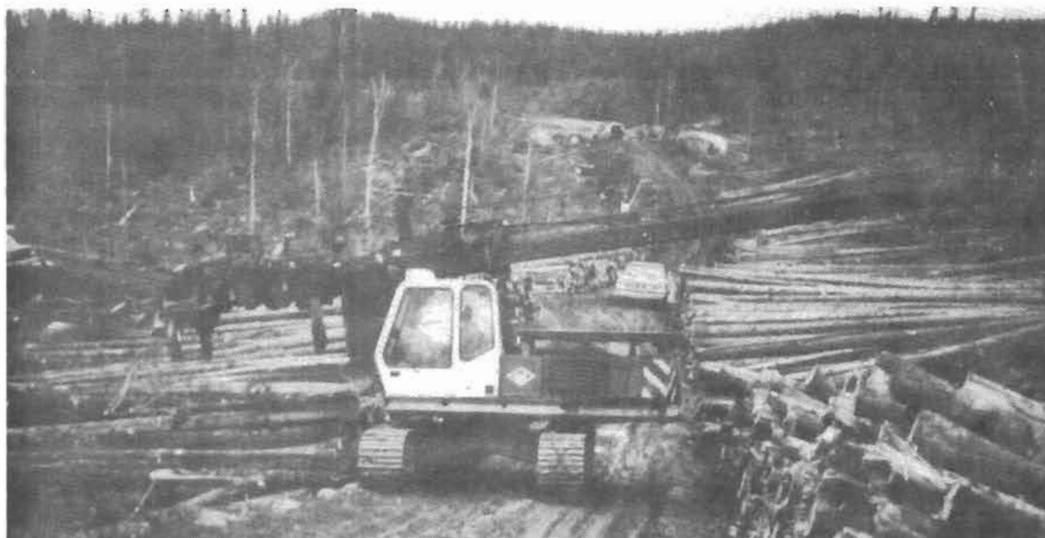
Une ébrancheuse au travail pour le compte de la compagnie Rexfor. Photo prise en 1990.
