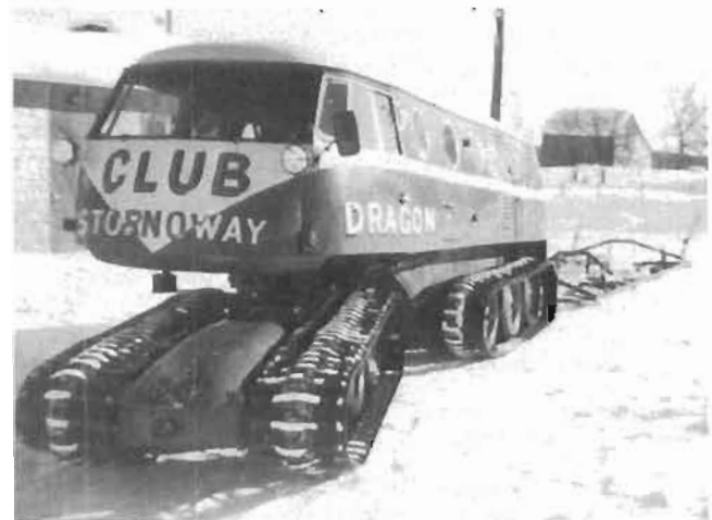
Ce «dragon», machine imaginée et «patentée» par Paul Poisson et Malcolm Rancourt, sert à entretenir le premier sentier de motoneige de Stornoway en 1967.
