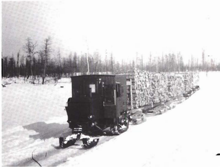
Un tracteur à essence tire un train de billots. Vers 1945 (Ville de L. M.).
