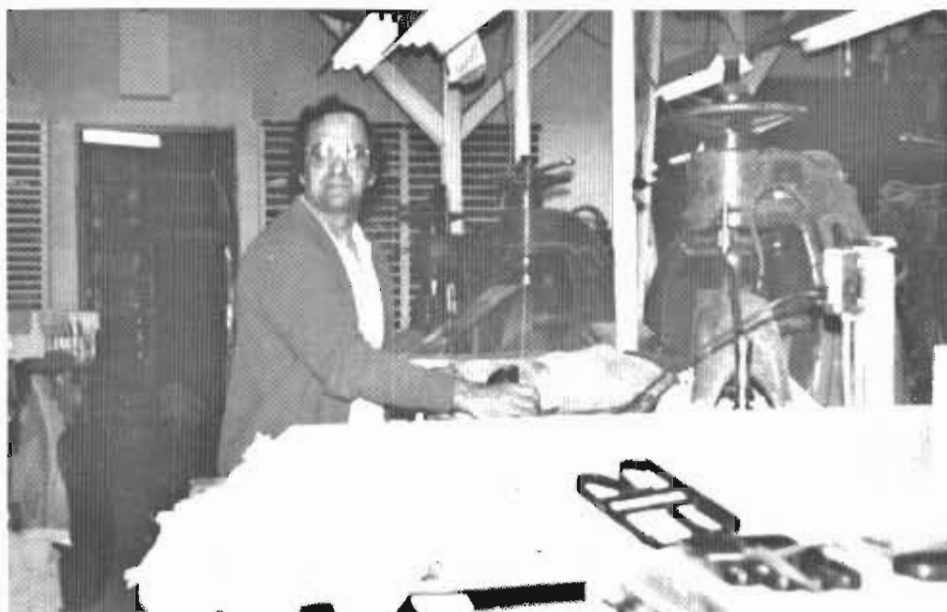
Florent Trépanier a travaillé 25 ans à la Consumers Gloves devenue Norton et ensuite Taskall. Il est photographié ici en janvier 1986 deux mois avant la fermeture de la manufacture de gants Taskall. Il est devant son "clicker", appareil servant à tailler les gants.
