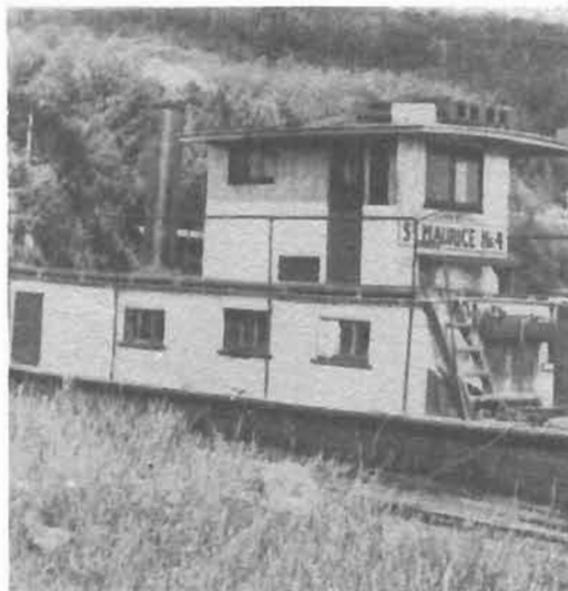
Alligator appeler aussi Crapeau bateau en bois avec engin à vapeur appartenant à la Cie Flottage du St-Maurice, 1956.
