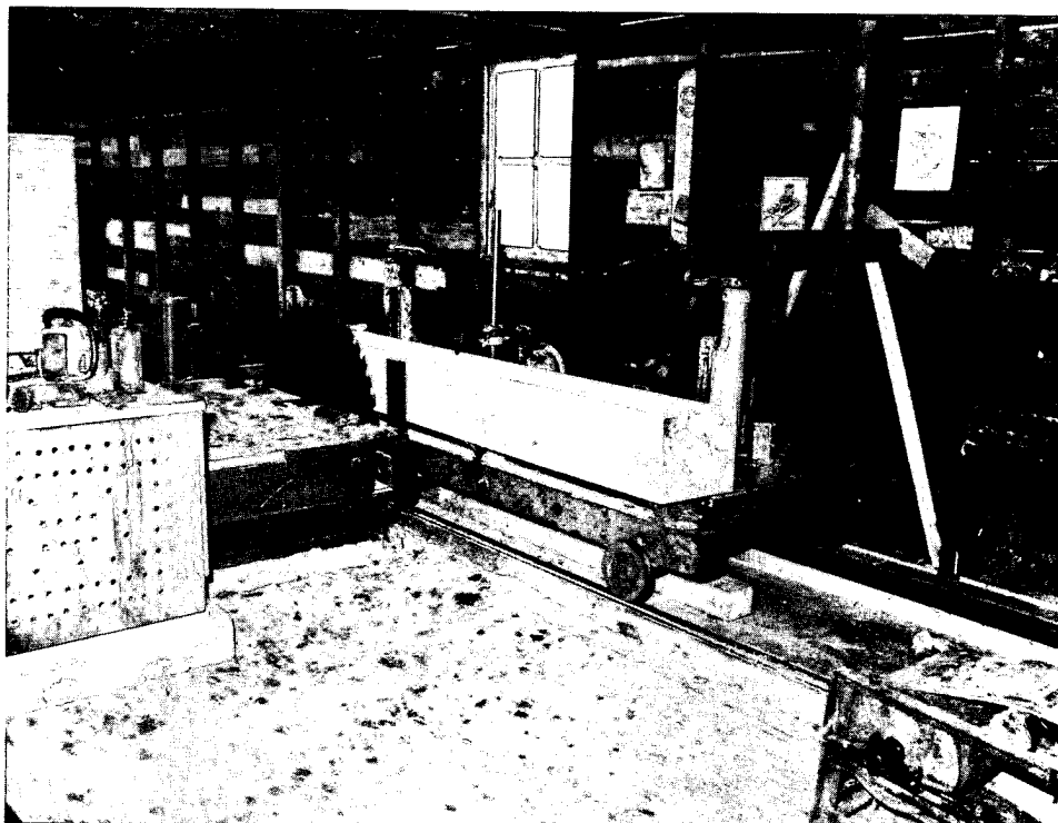
Moulin à scie de Luc Blouin: un billot équarri sur le charriot.
