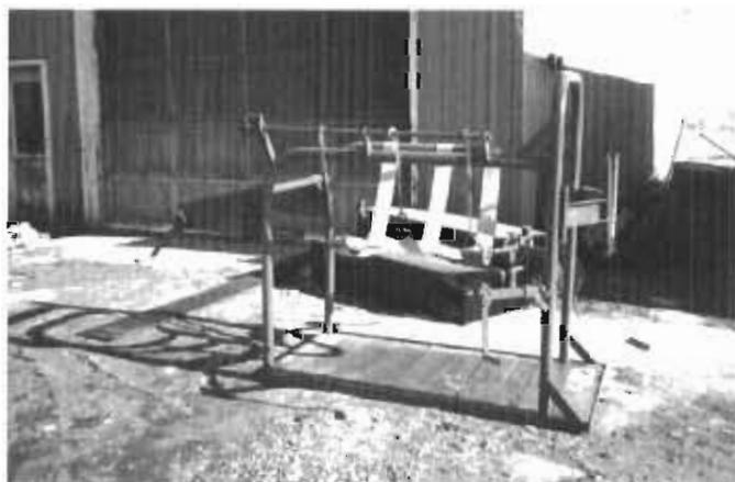
'Cage' pour tailler sabots des vaches. Robert Génier, soudure, fer forgé, fabrication, réparation et peinture de machines agricoles
