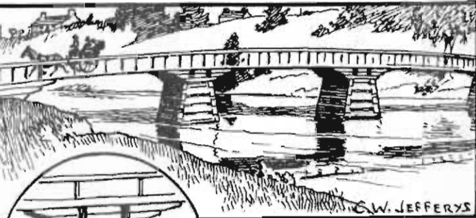
Pont de billes équarries Détail d'un pilier d'après Bouchette
