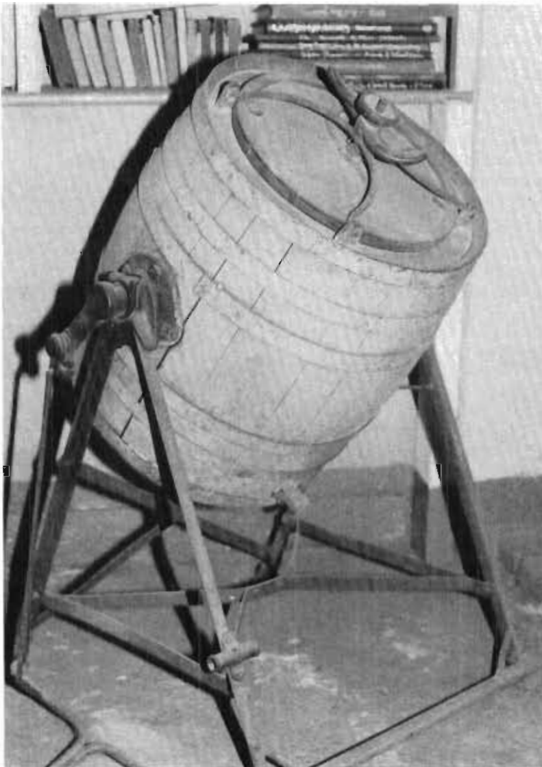
Ancienne boratte à beurre actionnée au pied.
