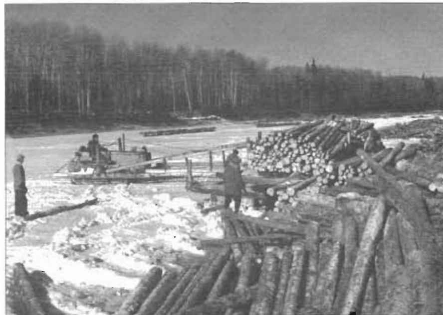
1950: The Mattagami River. The wood was hauled and placed on the frozen river. In the spring the logs floated downstream to the mill. / La rivière Mattagami. On transportait le bois pour le jeter sur la rivière glacée. Au dégel, les billots flottaient jusqu'à l'usine, emportés par le courant.
