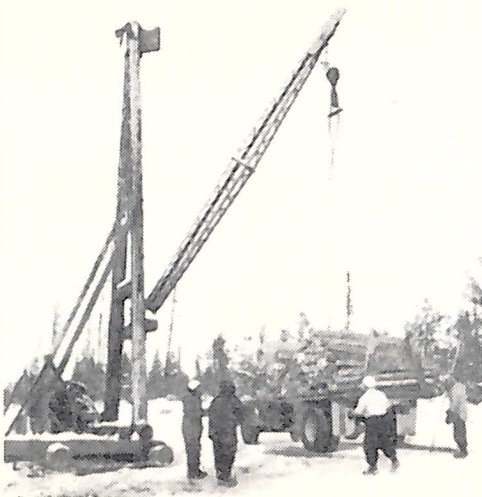
Mâts servant au chargement du bois aux camps de la Spruce Falls.
