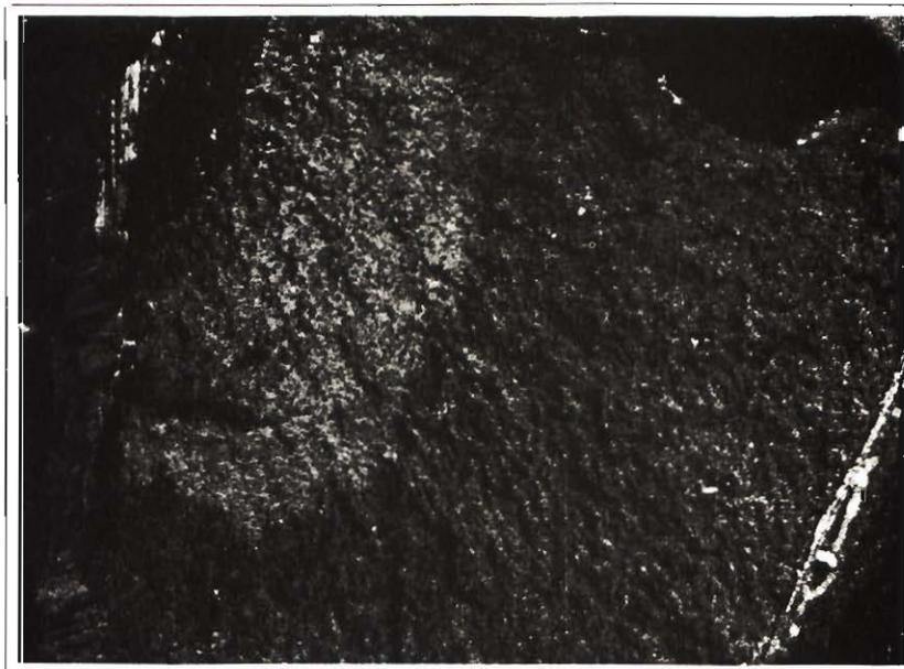
4. Gros plan de la zone plus pâle à la naissance de la crique, qui a donné lieu à la rupture de la roue. L'échelle du haut est en millimètres. Noter en haut à gauche la zone foncée dans l'encoignure et les dégâts mécaniques consécutifs à la rupture, à gauche (face de contact arrière).
